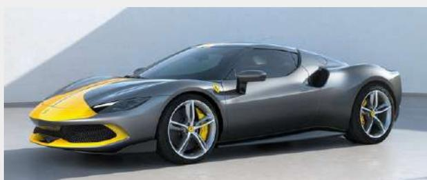
**FERRARI 296 GTB:** È dotata di un sistema ibrido composto da un V6 3.0 biturbo che eroga 663 CV, aiutato da un motore elettrico. La potenza complessiva è di 830 CV. La batteria da 7,45 kWh è ricaricabile dall'esterno e promette di percorrere fino a 25 km in modalità elettrica. L'auto pesa 1.470 kg, scatta da 0 a 100 km/h in appena 2,9 secondi e raggiunge i 200 in 7,3.
